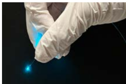
Eine einzelne Faser als Endoskop-Sonde.
