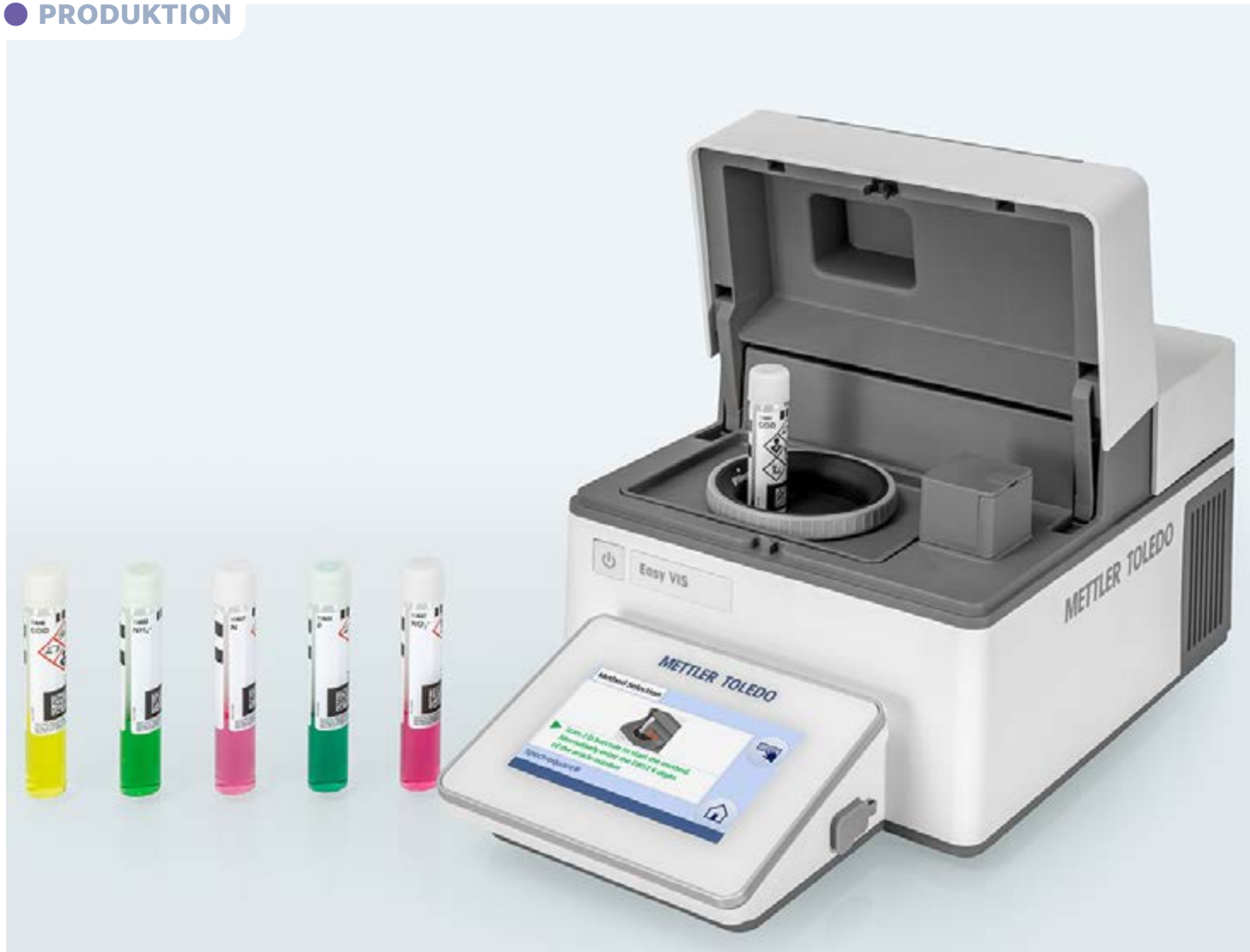
Die PathDetect-Funktion erkennt, welche Pfadlänge gemessen wird und reduziert Fehler. METTLER TOLEDO
